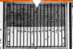
Fabricación de una forma papelera con su filigrana ("Arte de hacer papel", Lalonde)
